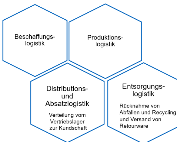
Abb. 4 Einteilung der Logistikbereiche anhand der Phasen des Produktionsprozesses (eigene Darstellung nach Angaben in (BVL, 2019))
